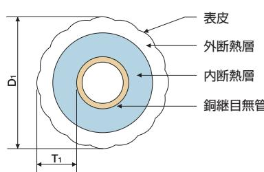
スケルトン天井などの配管に後加工なしで、そのまま使用できます。
